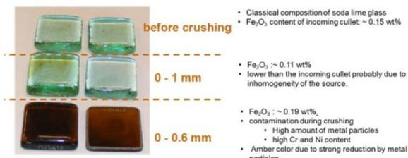
*Tests qualité d'un groisil après fusion montrant que le broyage plus fin du groisil à une force d'érosion plus importante sur l'acier du broyeur. Lors du broyage, des particules d'acier sont libérées dans le groisil et vont colorier intensément le verre après fusion.*
